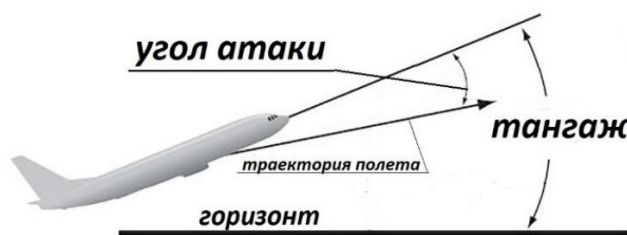
Рисунок 4.1 – Данные положения летательного аппарата
